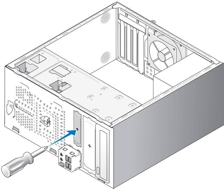
Alinhe a ponta da chave de fenda Phillips ao slot da placa de metal protetora e gire a chave para fora, para separar e remover a placa de metal.
